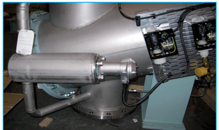
Câmara de flutuação customizada de aço inoxidável com interruptor de nível Trimod Switch para alarme de nível baixo.
