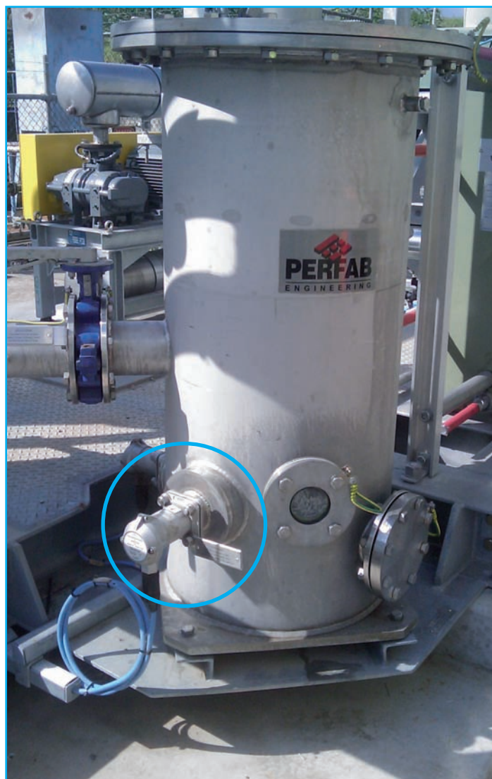
Interruptor de nivel Trimod Besta como alarma baja
